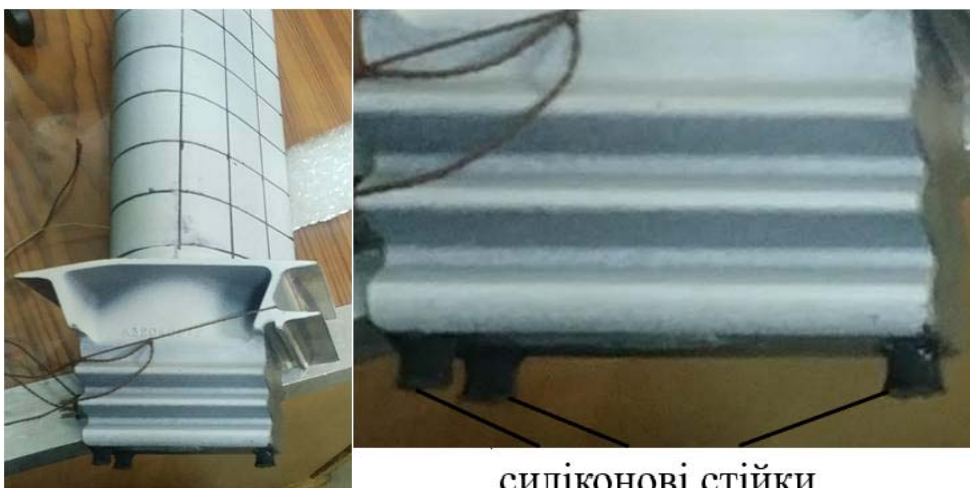
Рисунок 3 – розміщення лопатки при фактично вільних граничних умовах
