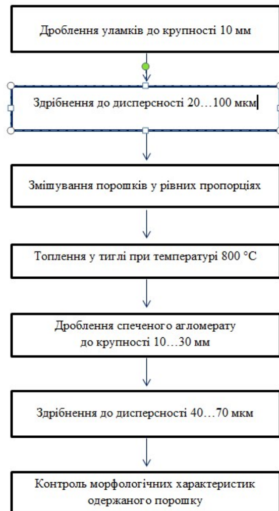
Рис. 1. Технологічна схема переробки бою скла та бракованих кристалевих виробів на стеклопорошок
