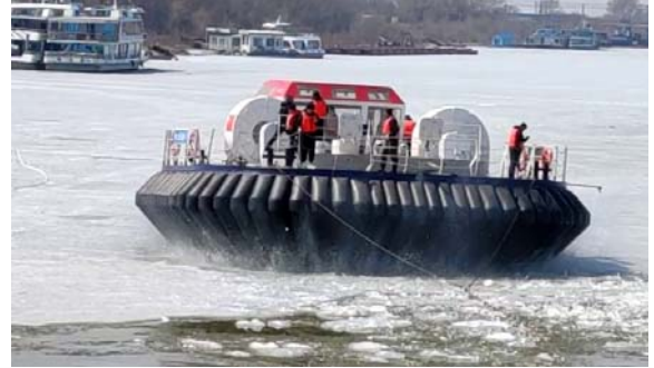
Рис. 11. Ледокольные испытания ЛПВП проекта АСП-55ІВ
