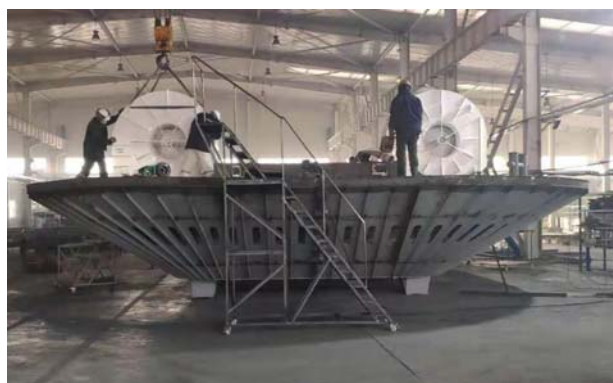
Рис. 9. Монтаж нагнетателів ПК ЛПВП на суднобудівельному заводі в КНР
