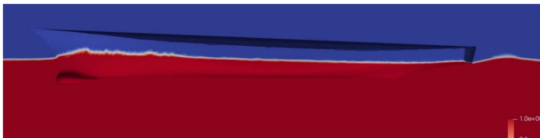
Рисунок 4 – Форма волновой поверхности вблизи корпуса модели при времени моделирования t = 17 сек.
