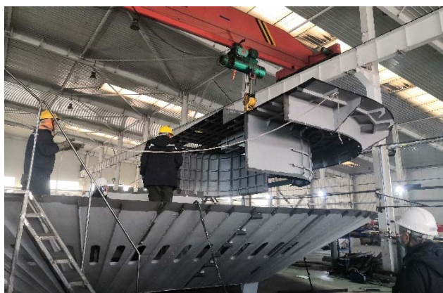
Рис. 8. Процес збирання корпусу ЛПВП на суднобудівельному заводі в КНР
