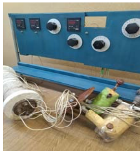
Рис.2. Основні елементи експериментального стенду для досліджень теплоакumuлюючих систем та їх елементів
