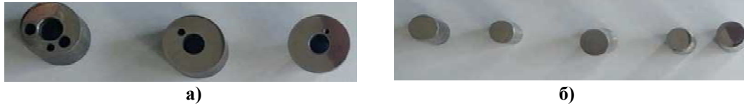
Рис.1 – Мікрошліфи деталей паливної апаратури дизелів а) розпилювач форсунки ФД-22; б) голка форсунки ФД-45;
