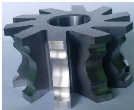
Рис. 4. Загальний вигляд спеціальної фрези для обробки профілю регулюючого кулачка
