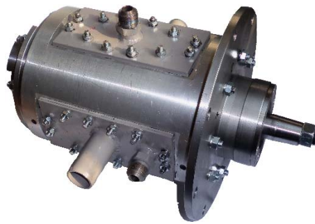
Рис. 1. Роторно-поршневий двигун об'ємної дії із шарнірно-кулачковим механізмом перетворення руху типу 12РПД-4,4/17,5
