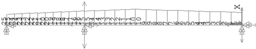
Рис. 3. Скінчено-елементна модель бортового перекриття із прикладеним навантаженням
