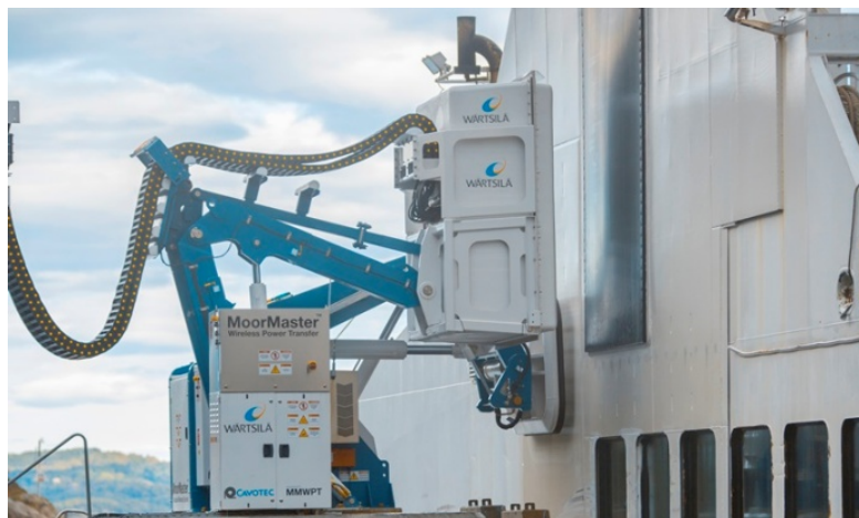
Рис. 3. Фото комплексу індукційного заряду парому «Ампер»
