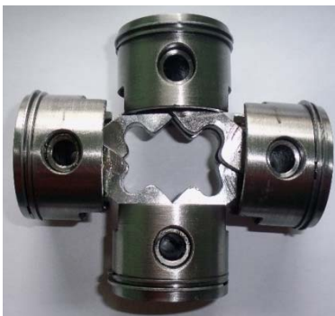
Рис. 2. Деталі перетворення руху роторно-поршневого двигуна: а – шарнірний чотирикутник у зборі з поршнями; б – регулюючий кулачок
